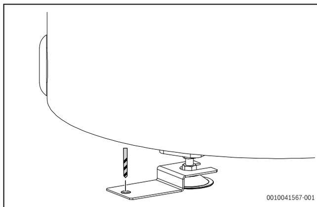
Fig. 8 Staffa di fissaggio
